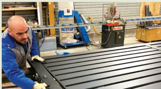
Toujours désireux de mieux vous servir, GEDIMAT est équipé d'un centre d'usinage. Grâce à cet équipement, nous sommes en mesure de réaliser des portails et clôtures aluminium sur mesure.
