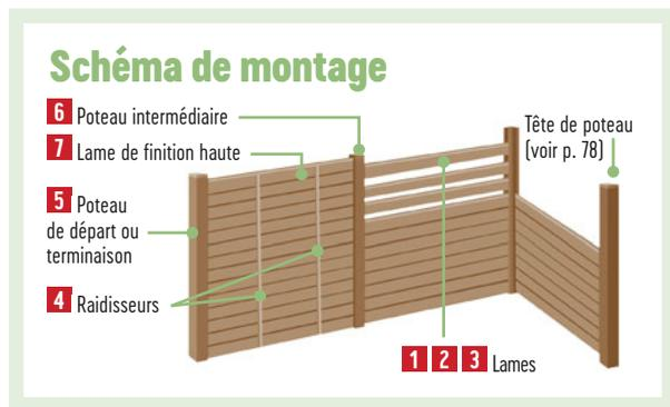
Attention : pour une pose sur platine, évitez les hauteurs de clôture supérieures à 120 cm. Au-delà, pose scellée obligatoire.
