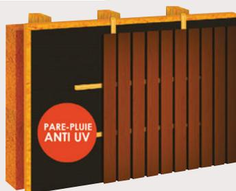
Écran. Conforme à une utilisation en pare-pluie. Entraxe 60 cm. Résistance UV 5000 heures. Rouleau de 1,5 x 50 m
