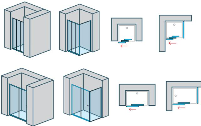
**Paroi retour pour porte pivotante, pivotante + fixe, pliante et coulissante**
