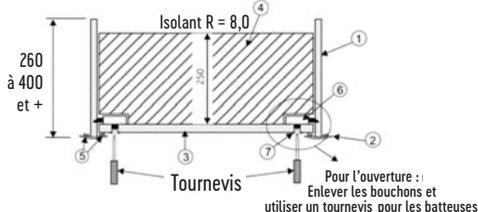
Pour l'ouverture : Enlever les bouchons et utiliser un tournevis pour les batteuses
