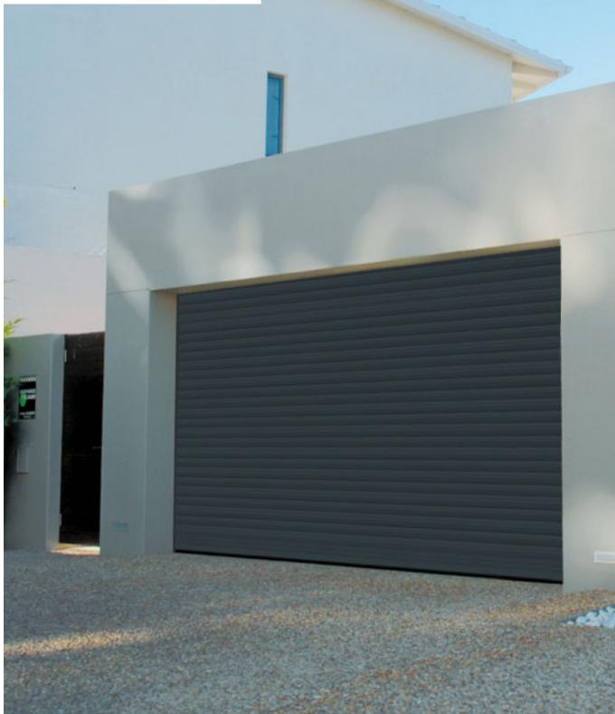
Porte de garage à enroulement avec tablier en lames aluminium isolées de 77 mm et 19 mm d'épaisseur. Coffre de 300 mm en aluminium et coulisses de 10 x 35 mm. Pose en applique intérieure derrière linteau. Dispositif de sécurité anti-relevage et anti-chute + manœuvre de secours intégrée.
