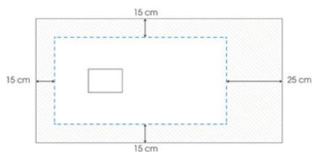
Zone maximale de découpe. Découpe possible sur maximum 3 des 4 côtés (si le receveur n'est pas totalement encastré, les côtés découpés doivent être positionnés contre les murs)
